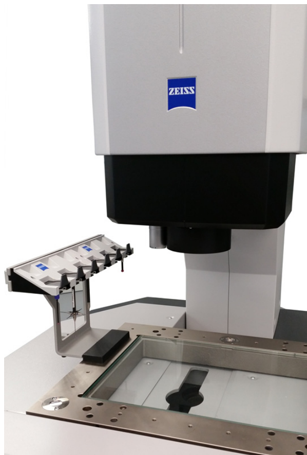
Abb. 3: MSR O-INSPECT fertig montiert am KMG
