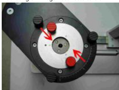
Abbildung 6: Schließen der roten Feststellschrauben
