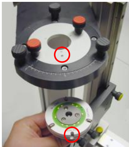
Abbildung 5: Einlegen des Tastertellers
