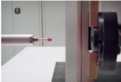
Abbildung 12: Einstellung der Prismenhöhe
