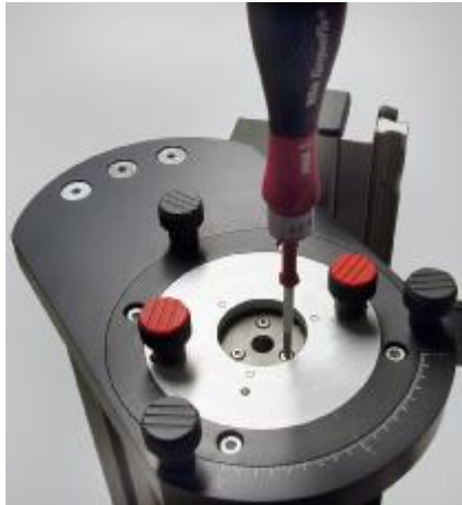
Abbildung 7: Drehmomentschraubendreher für die Tastertellerschrauben
