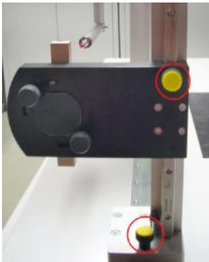
Abbildung 13: Öffnen der gelben Feststellschrauben
