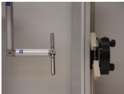
Abbildung 16: Würfel mit aufgeschraubten Edelstahlverlängerungen
