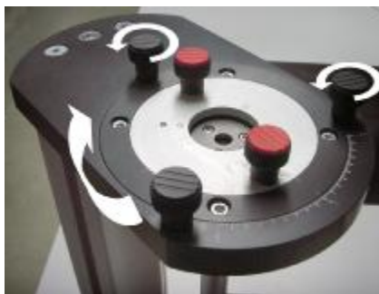
Abbildung 8: Drehen der oberen Winkelskala
