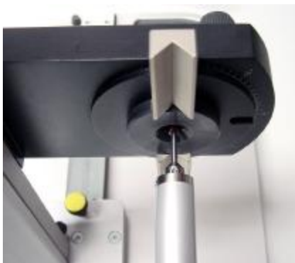
Abbildung 14: Draufsicht beim zentrieren des Tasters
