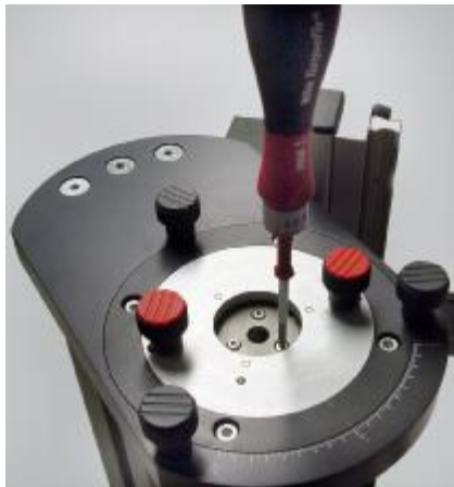
Abbildung 11: Drehmomentschraubendreher für die Tastertellerschrauben
